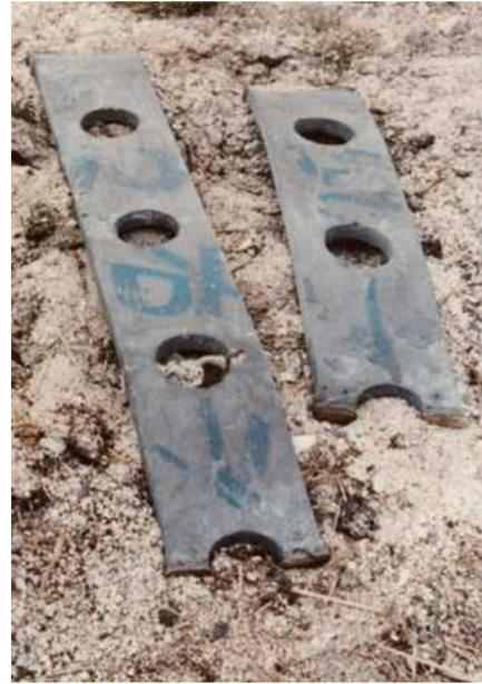
リンクプレートを切断し、倒壊させた工事例 (写真はマークス島電波塔爆破解体工事)
